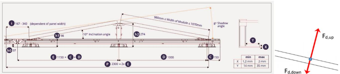
Les composantes horizontales des forces perpendiculaires (F) sont utilisées pour la détermination de la résistance au glissement du système.
