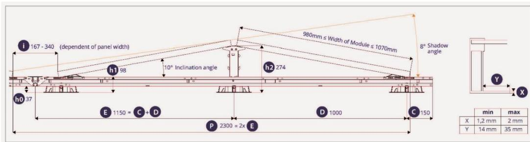
Les composantes horizontales des forces parallèles (F) sont utilisées pour la détermination de la résistance au glissement du système.
